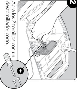
Abra los 2 tornillos con un destornillador corto.
