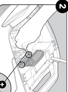
Au moyen d'un tournevis court, desserrez les 2 vis.
