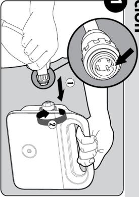
Conecte el cable flotante a la fuente de alimentación.
