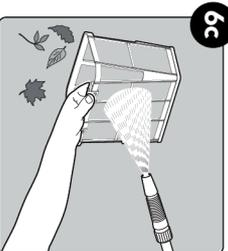
Nettoyez le panier de filtrage au moyen d'un jet d'eau.
