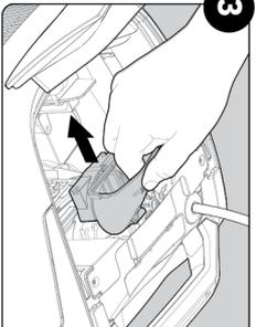
Tire de hacia atrás la tapa del impulsor para abrirla. Limpie las impurezas atrapadas alrededor del impulsor. Monte la tapa del impulsor.
