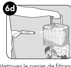
6d Nettoyez le panier de filtrage au moyen d'un jet d'eau.
